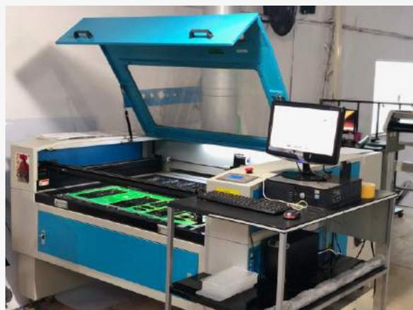
Laser (Corte e Gravação) área de corte: 0,80x1,20m
