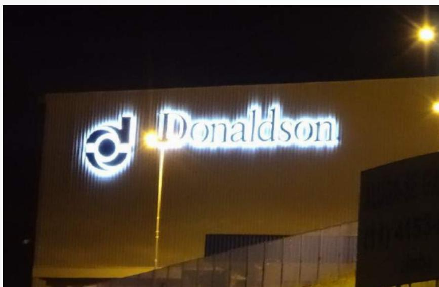
Letras em aço galvanizado retroiluminadas (iluminação com módulos de led)
